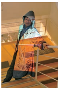
1 再帰性投影技術による「光学迷彩」(撮影:Ken Straiton) “Optical Camouflage” based on Retroreflective Projection Technology
