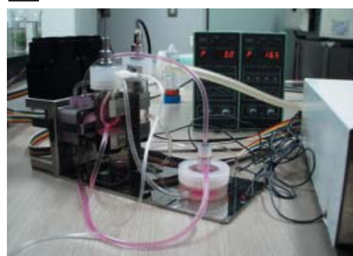
図2 血管壁細胞の混合培養系装置
