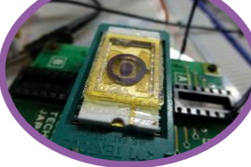
振動発電のデモ。振動させると、奥の計測器で発電量が測定される。目標は0.1Gで10mW。腕時計を動かすことができる電力の1,000倍。
