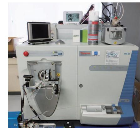
▲タンパク質の質量を正確に測定する「質量分析機」
