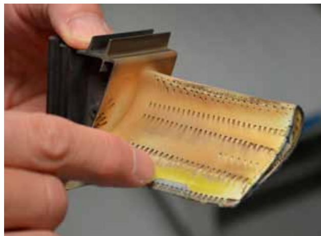
実際に飛行機のエンジンで使われていたタービンブレード
