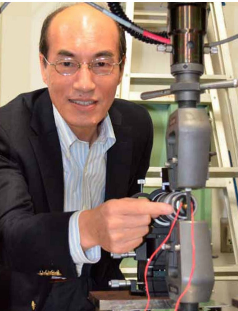
5トンの力で材料を引っ張って壊して調べる装置 「ここにセットします」と香川教授
