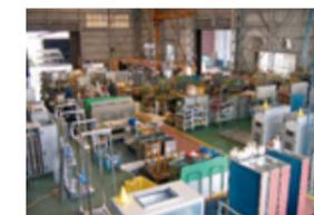
図6 工場での在庫の渋滞の様子。中間製品(仕掛品)が大量に工程間に積まれている。
