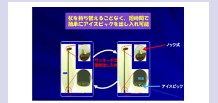
図1. 冬用杖: アイスピックの出し入れワンタッチ 凍結路面用杖
