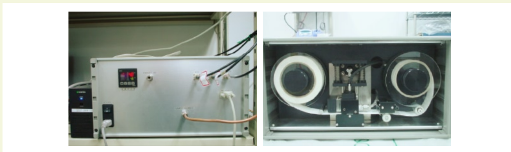
図1 カノマックス社と共同開発したブラックカーボン自動連続測定器COSMOS (Continuous Soot Monitoring System)
