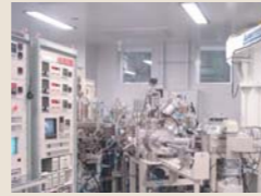
先端研に設置されているウェハ対応常温接合装置
