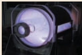
【図2: 常温で無機や金属薄膜を結晶化させる技術とパテントプールによる技術移転】 常温プラズマ結晶化装置外観 チャンバー内に発生させたプラズマ
