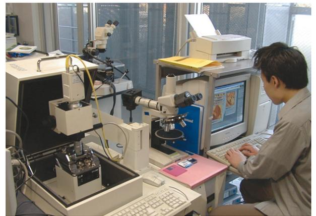
原子間力顕微鏡を改良した圧電応答顕微鏡。ナノスケールでの局所物性評価が可能。
