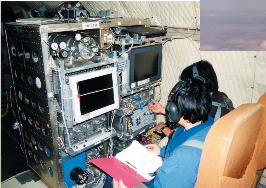
東京大学で開発した窒素酸化物測定装置をNASA航空機に組み込んで測定を行う東京大学チーム
