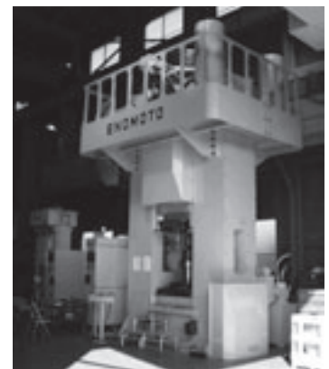
図●榎本機工（神奈川県城山町）に設置された500トンプレス装置。複合材料のビレットを製造する
