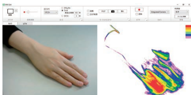
1 コンピュータビジョンを応用した重度障害のある人のわずかな動きをとらえるソフト「OAK」 OAK: a switch software for people with severe and multiple disabilities using computer vision
