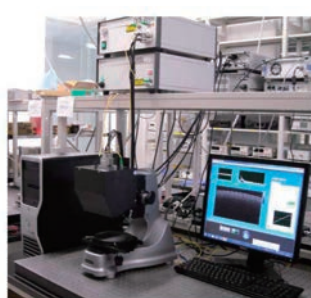
2 波長掃引OCTシステムと高速取得画像 Swept-Source OCT system and High-speed Acquisition Images
