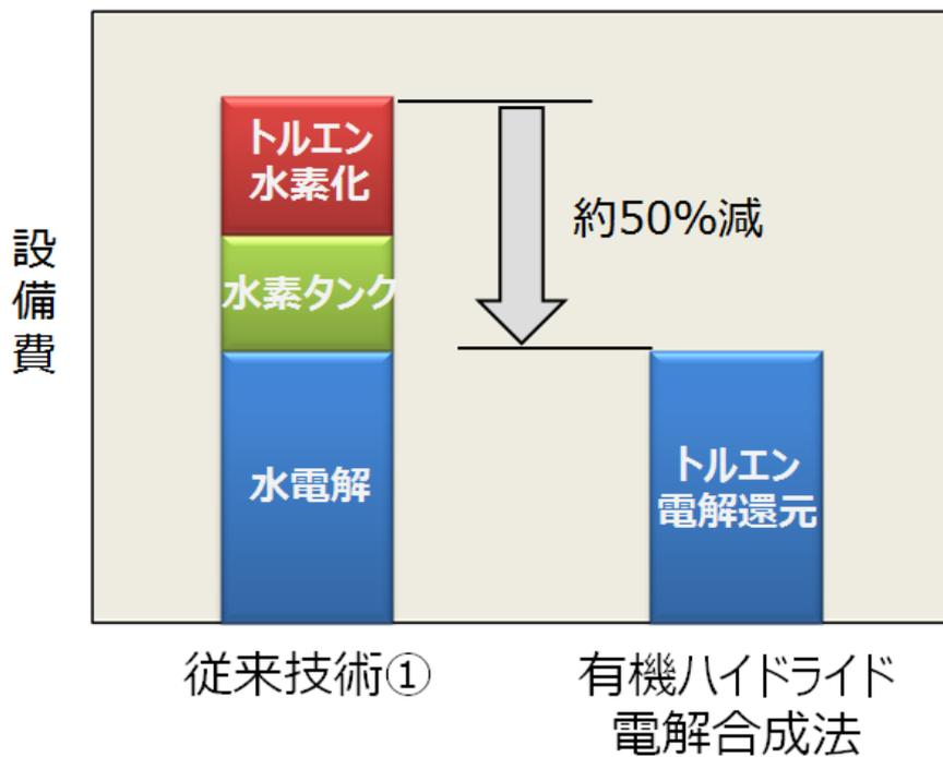
※ 水素6,000Nm<sup>3</sup>/h(3MW規模)時の設備費
