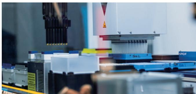
▲一定量の試料や試薬を高速・高精度で多数の試験管の中に入れる自動分注機。ライフサイエンスの研究現場では必須の実験装置
