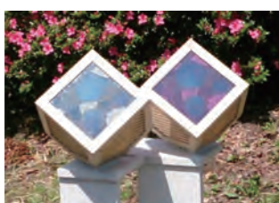
② 蓄電機能内蔵太陽電池を用いたスマートフォン充電器 Smart phone charger using energy-storable solar cells
