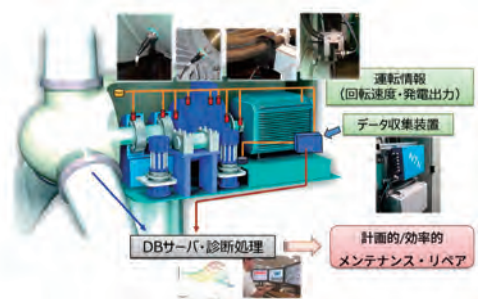
3 風力発電スマートメンテナンス技術研究開発 Wind power SMART MAINTENANCE technology research and development
