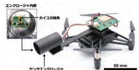
3 カイコガ触角を搭載したバイオハイブリッドドローン The bio-hybrid drone with a mounted silkworm antenna for odor source localization.
