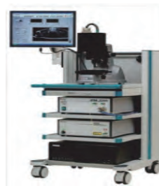
2 波長掃引OCTシステムと高速取得画像 Swept-Source OCT system and High-speed Acquisition Images
