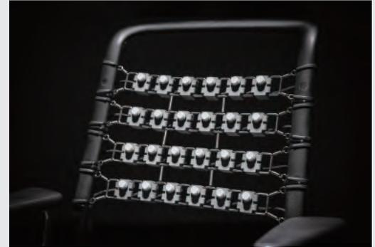
▲背もたれや座面に配置された回転接触子(モーター)群が同時に回転し、皮膚表面に広範囲に捻りを加えることで触覚を提示
