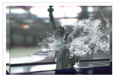
1 複雑形状をした構造物と流体の連成相互作用を含む自由界面シミュレーション
