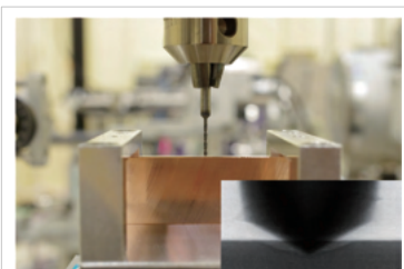
3 ドリル加工の高速X線撮像
